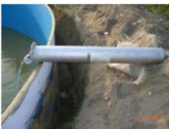
Mit eisen-/manganhaltigem Brunnenwasser wurde über den plocher bioreaktor das Schwimmbecken gefüllt.
